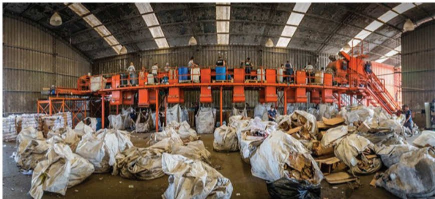
Imagen 7. Cinta en altura, los bolsones con material separado se encuentran a distancia de los recuperadores urbanos
